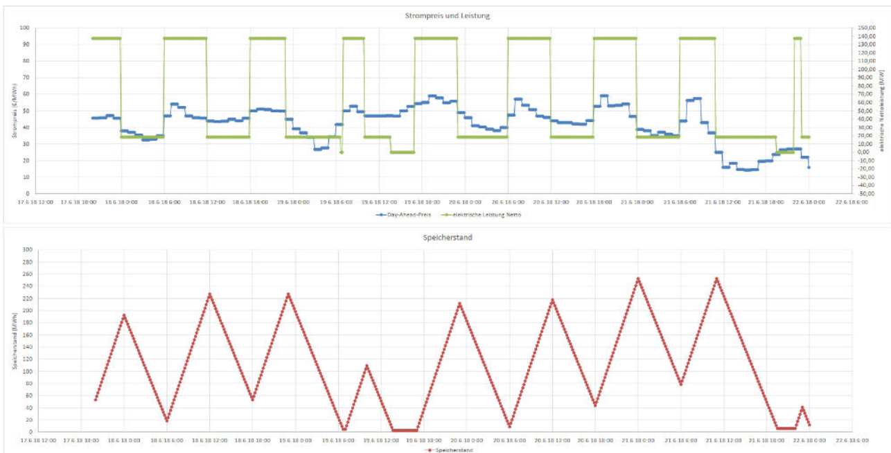
Abbildung 4 Typischer Sommerbetrieb ohne Fernwärmeproduktion
